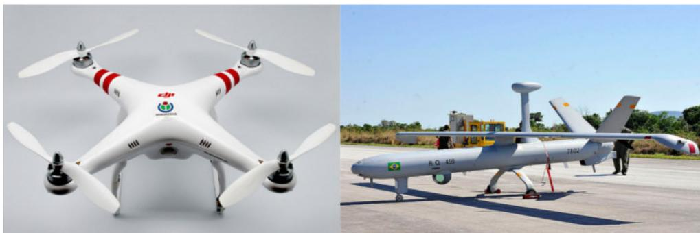
Figura 1: Esquerda: drone do tipo multi-rotor “quadricóptero”. Direita: drone do tipo asa fixa. Fontes: commons.wikimedia.org e upload.wikimedia.org/wikipedia/commons
